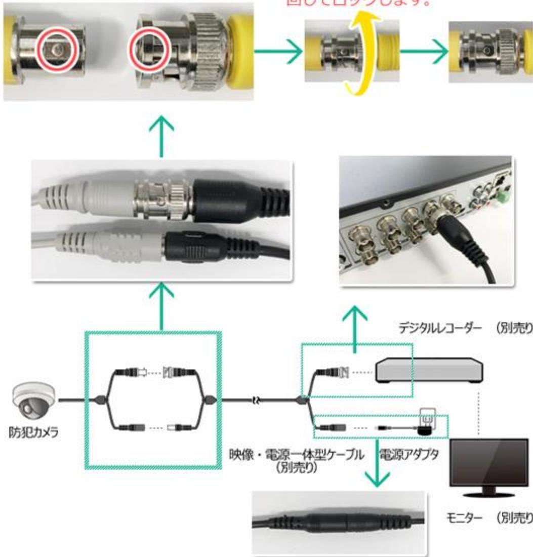
接続先の機器に合わせてモード変更を行って下さい。
