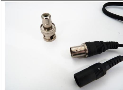
RCA ピンプラグを BNC に変換するコネクタを用意いたします。
